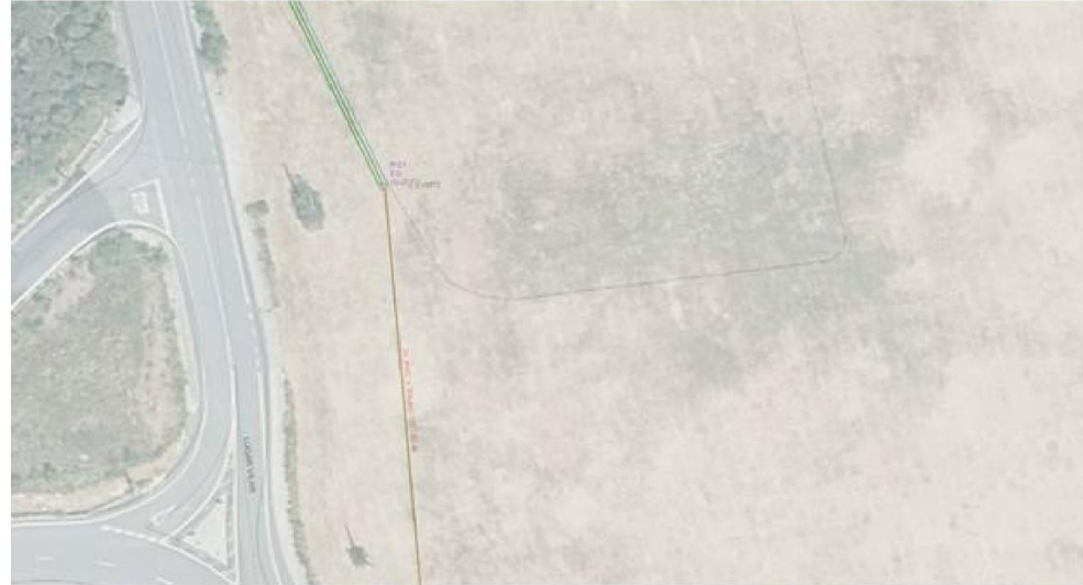
NIGRÁN: Hay conducción de Telefónica en el entorno de la nueva senda proyectada, pero se considera que no hay afectación pues no son necesarios movimientos de tierra importantes. Únicamente considerar la puesta cota de la tapa de una arqueta existente pero que ya se ha incluido en el PEM del proyecto.
