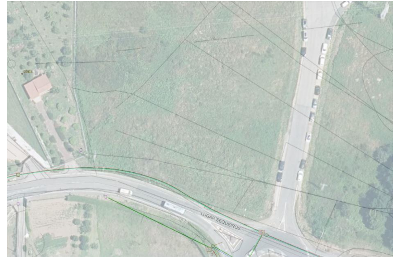
CALDAS: Hay conducción de Telefónica en el entorno de la nueva senda proyectada, pero se considera que no hay afección pues no son necesarios movimientos de tierra importantes.
