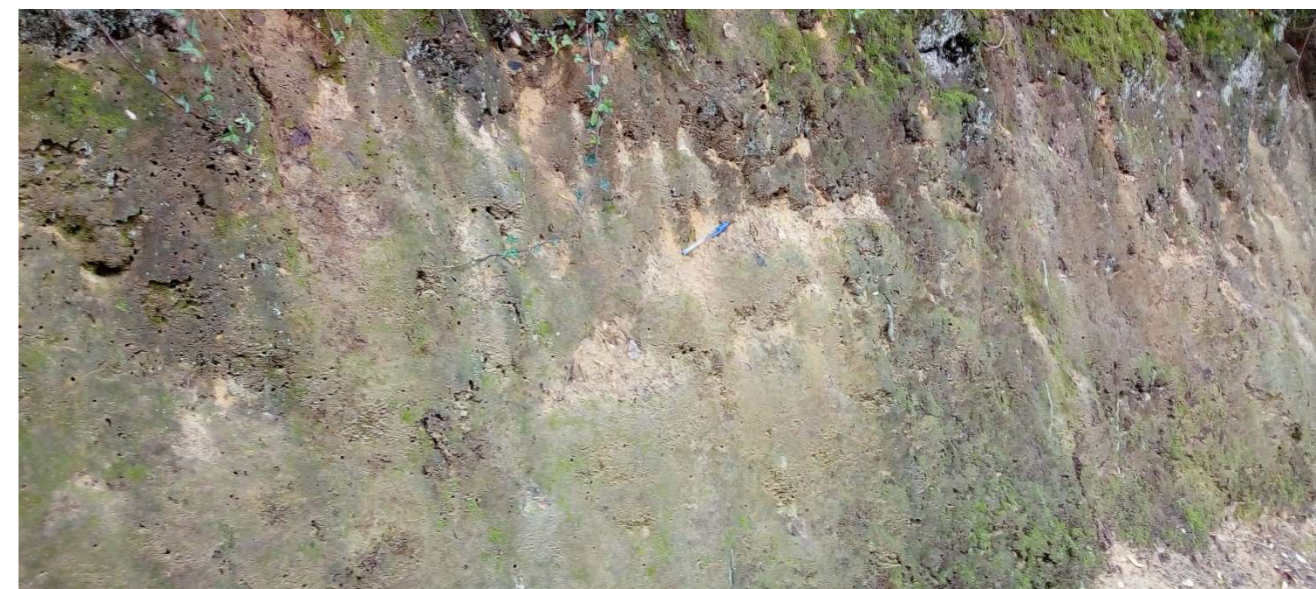
Vista general de afloramiento de "Serie de Ordenes" completamente meteorizado (GM V)
