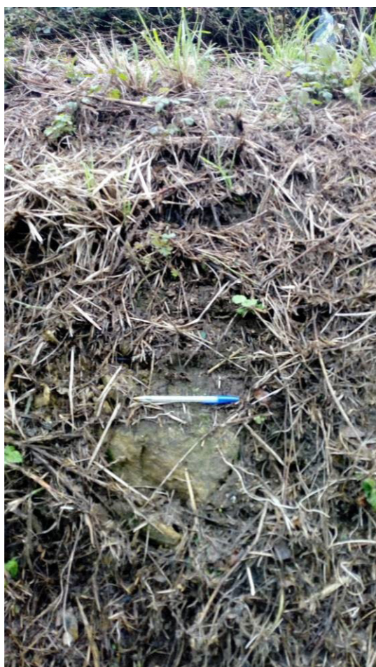
Detalle contacto entre sustrato correspondiente a la "Serie de Ordenes" y el horizonte edáfico de tierra vegetal
